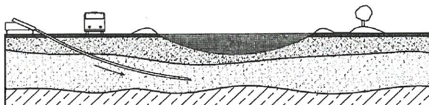
Rys.1) Przewiert pilotażowy
